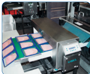
METAL SHARK® BD en línea detrás de una máquina de dibujo profundo
